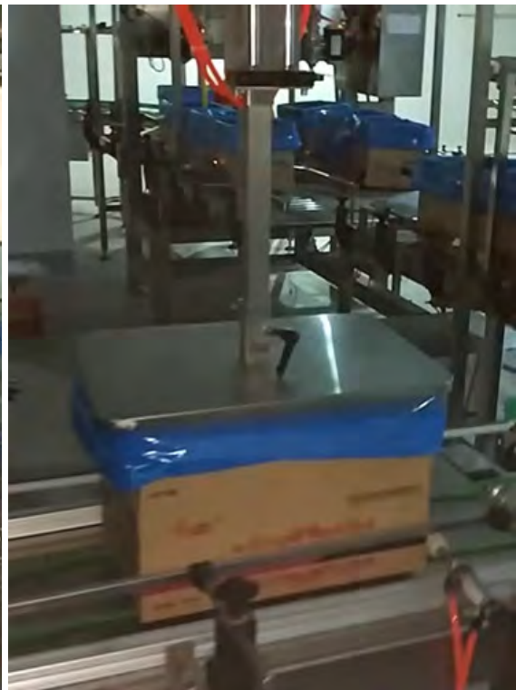
Продувка воздухом для удлинения мешков в коробках
