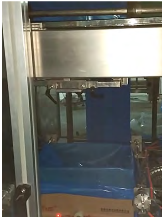
Складывание мешков поверх коробки
